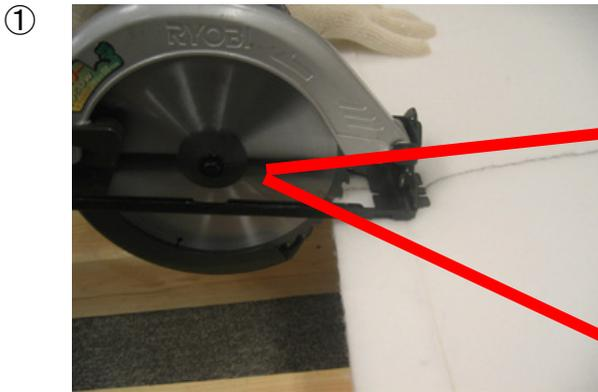
電動丸ノコのチップソー(ノコ刃)を裏返して装着します。
