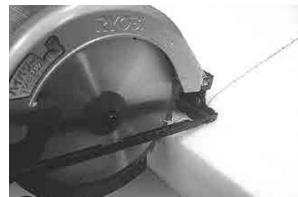
図2 厚いボードタイプは、電動丸ノコの刃を裏返して装着しカットします。繊維がからむ事無くカットできます。
